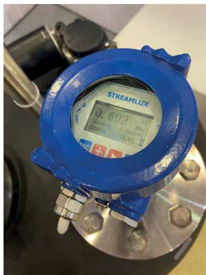
Рис. 1. Радарный уровнемер STREAMLUX RD8000: а – внешний вид базового исполнения; б – отображение измеренных значений на дисплее
