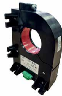
Рис. 5. Разъемные датчики тока, которые не требуют демонтажа токовой цепи и крепятся непосредственно на токовой шине: а – ПИТ-xxx-ТР-4/20-Б20х20 с отверстием под токовую шину 20 × 20 мм и диапазоном измерения тока 300 А; б – ПИТ-xxx-ТР-4/20-Б50-М для крепежа на шине диаметром до 50 мм, диапазон измерения 1000 А
