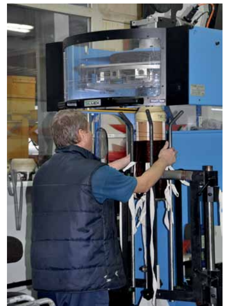
Рис. 2. Станок для вертикальной намотки обмоток высокого напряжения
