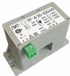
Рис. 5. Разъемные датчики тока, которые не требуют демонтажа токовой цепи и крепятся непосредственно на токовой шине: а – ПИТ-xxx-ТР-4/20-Б20х20 с отверстием под токовую шину 20 × 20 мм и диапазоном измерения тока 300 А; б – ПИТ-xxx-ТР-4/20-Б50-М для крепежа на шине диаметром до 50 мм, диапазон измерения 1000 А
