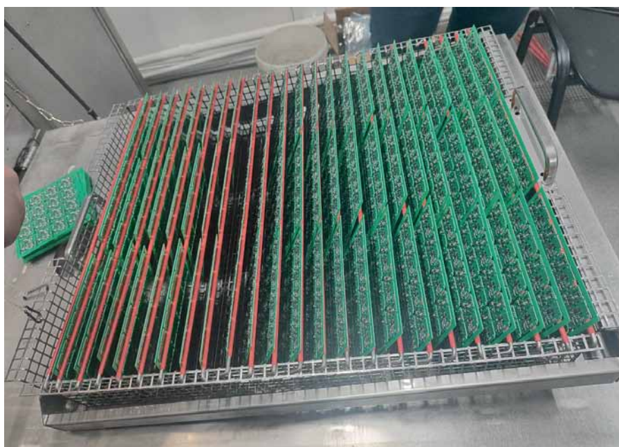
Рис. 3. Размещение печатных плат в корзине установки «УСОТП-1»
