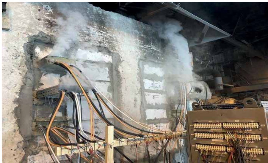
Рис. 3. Испытания огнестойкой кабельной линии в лабораторных условиях
