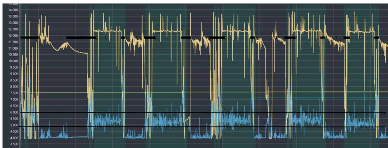
Рис. 6. Диаграмма работы датчика в гидросистеме управления стрелой и ковшом спецмашины по добыче руды
