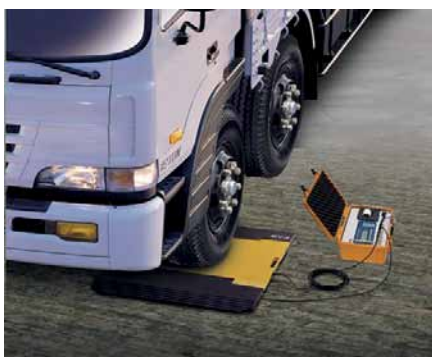
Рис. 2. Размещение грузоприемной платформы под колесом автомобиля
