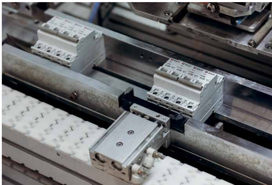
Рис. 2. Автоматизированное производство модульного устройства ВА 47-63N PROXIMA в п. Ставрово
