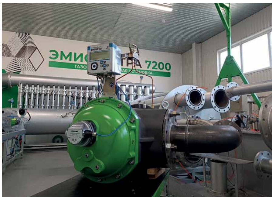
Рис. 4. Комплекс учета газа «ЭМИС-Эско 2230» на базе ротационного счетчика «ЭМИС-РГС 245» типоразмера G 1000 (Ду 200)
