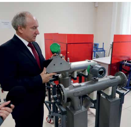
Рис. 1. Генеральный директор ГК «ЭлМетро» А. В. Жестков демонстрирует посетителям компании кориолисовые расходомеры различного типоразмера
