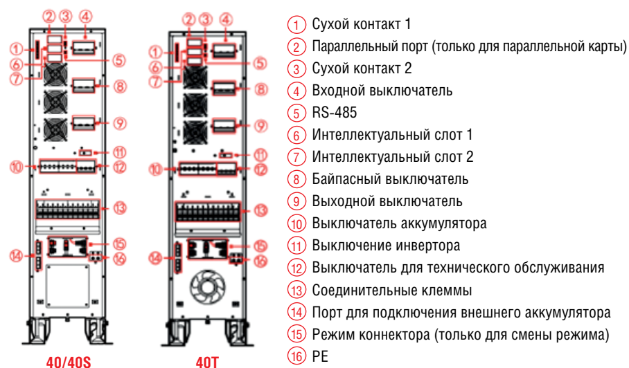
Рис. 2. Конструкция задней панели ИБП VGD-II-40K33HC
