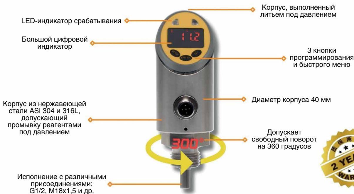
Рис. 2. Внешний вид и основные характеристики датчика температуры SENTINEL
