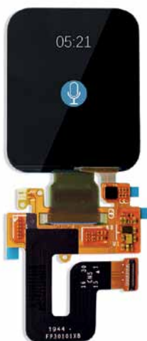
Рис. 6. Квадратный AMOLED-дисплей TA018NHV01 с экраном 1,78 дюйма
