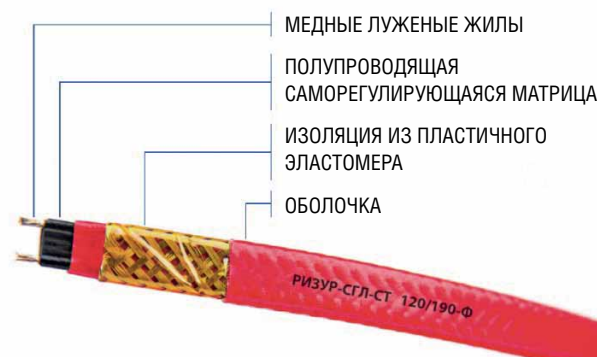
Рис. 4. Конструктивные элементы саморегулирующегося греющего кабеля РИЗУР-СГЛ
