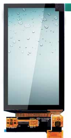
Рис. 7. AMOLED-дисплей TA055FHV03 с экраном 5,44 дюйма
