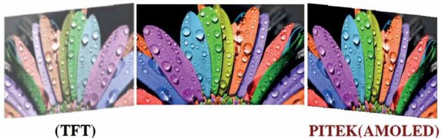
Рис. 2. Широкий угол обзора на дисплее с матрицей AMOLED
