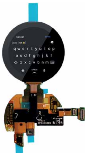
Рис. 5. Круглый AMOLED-дисплей TA012WVC01 с экраном 1,2 дюйма
