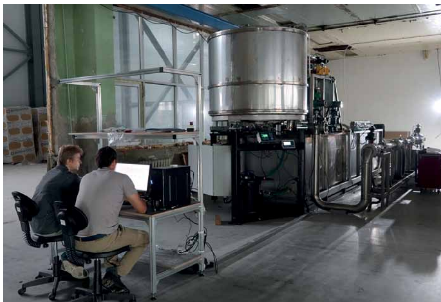
Рис. 2. Вакуумная печь для высокотемпературной конструкционной пайки измерительных приборов
