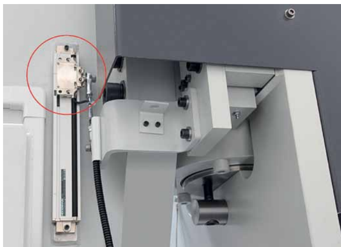
Рис. 2. Линейный энкодер в составе листогибочного прессы
