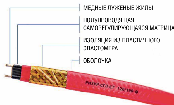
Рис. 4. Конструктивные элементы саморегулирующегося греющего кабеля РИЗУР-СГЛ
