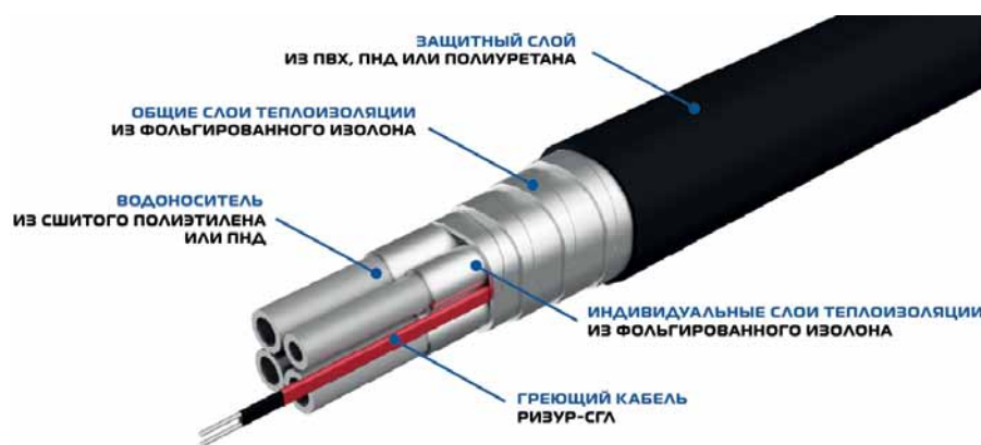
Рис. 1. Конструктивные элементы гибкого предизолированного пучка труб РИЗУРПАК-ЖКХ
