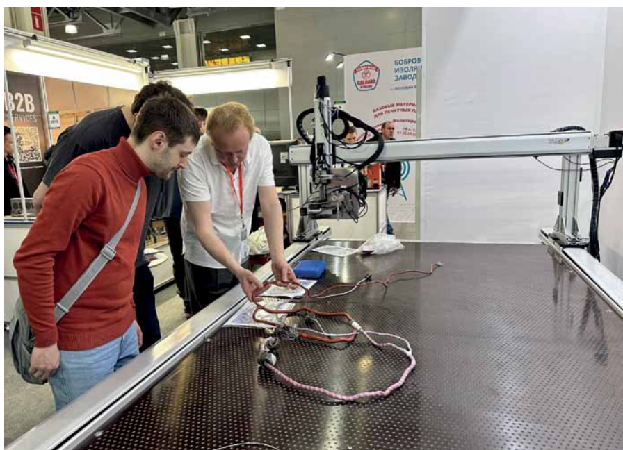
Рис. 1. Посетители выставки ExpoElectronica-2024 рассматривают готовый кабельный жгут на станке ЧПУ для раскладки проводов на плазе
