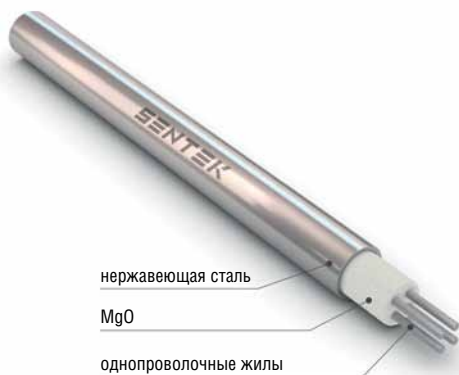
Рис. 3. Термопарные и нагревостойкие кабели СЕНТЕК с минеральной изоляцией в металлической оболочке
