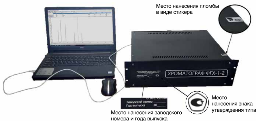
Рис. 2. Общий вид хроматографа газового портативного ФГХ в исполнении УД: стационарный вариант
