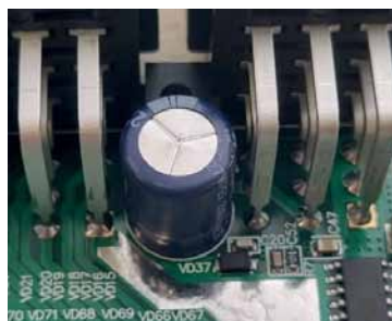
Рис. 4. Результаты отмывки электролитических конденсаторов в Гидроноле Н18
