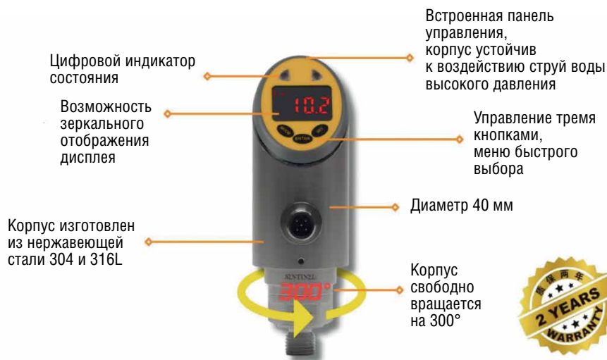
Рис. 5. Датчики давления серии SE: внешний вид и основные конструктивные характеристики
