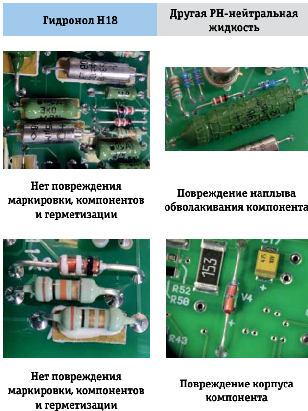
Рис. 5. Влияние на компоненты рН-нейтральных отмывочных жидкостей разных отечественных производителей
