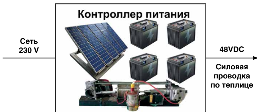
Рис. 4. Схема организации электропитания теплицы
