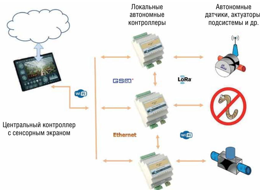
Рис. 3. Организация системы управления тепличным комплексом «АРГО»
