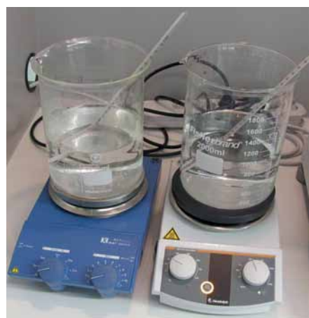
Рис. 3. Процесс нагрева отмывочных жидкостей для оценки потерь при испарении
