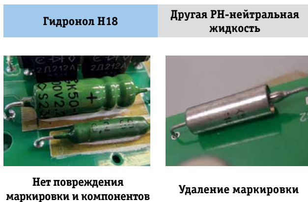
Рис. 2. Совместимость Гидронола Н18 и другой отечественной рН-нейтральной отмывочной жидкости с маркировкой компонентов и печатного узла
