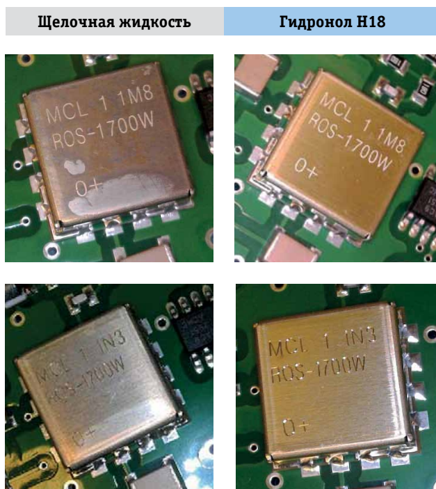
Рис. 1. Компоненты после отмывки щелочной жидкостью и рН-нейтральной жидкостью Гидронол Н18
