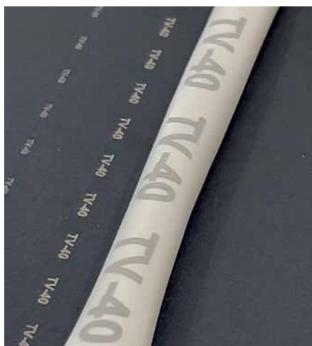
Рис. 4. Маркировка, нанесенная УФ-лазером на трубку 305 ТВ-40
