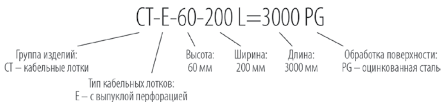
Рис. 3. Пример маркировки кабельного лотка
