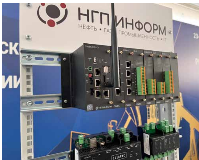
Рис. 2. Блочно-модульный ПЛК SilkVIC
