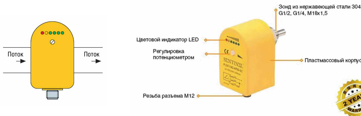
Рис. 4. Датчик потока серии PLSX
