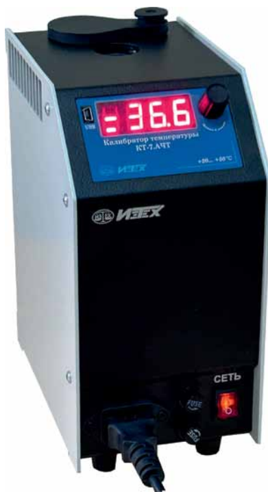
Рис. 1. КТ-7.АЧТ для поверки бесконтактных медицинских термометров
