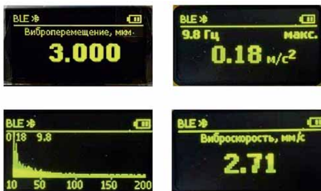
Рис. 3. Отображение данных о техническом состоянии оборудования на OLED-дисплее АВ5
