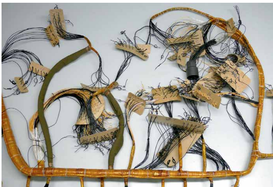
Рис. 3. Раскладка проводов в оснастку с имитацией разъема
