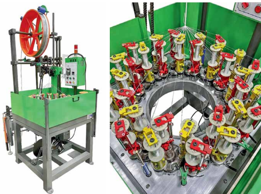
Рис. 6. Станок для оплетения жгутов на 36 катушек с доработкой компании «Протех»
