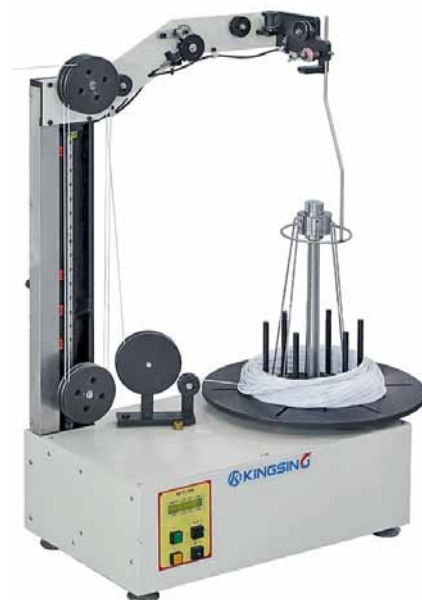
Рис. 1. Станок для перематки проводов с бухт на катушки
