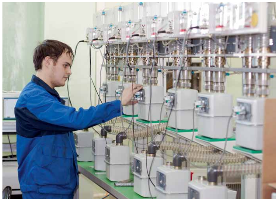
Рис. 3. Работа на поверочной установке QRM
