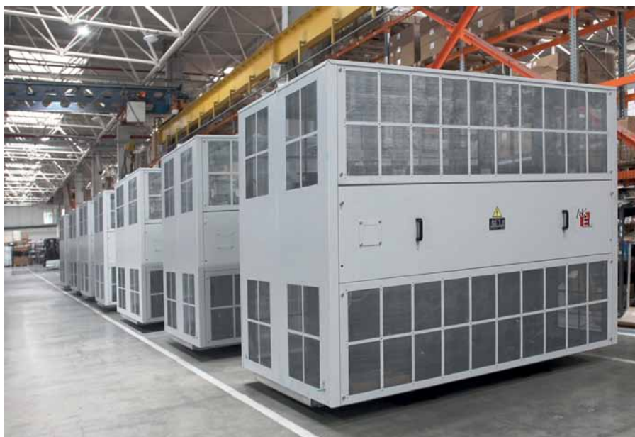
Рис. 3. Сухой трансформатор в защитном кожухе
