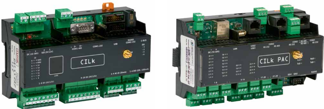
Рис. 1. Контроллеры ООО «НГП Информ»: а – компактный ПЛК Cilk; б – модульный ПЛК CilkPAC
