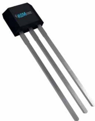
Рис. 2. Аналоговый ДМП в корпусе TO92UA
