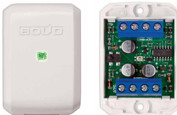
Рис. 6. Регистратор импульсов С2000-АСР2: внешний вид и внутреннее устройство
