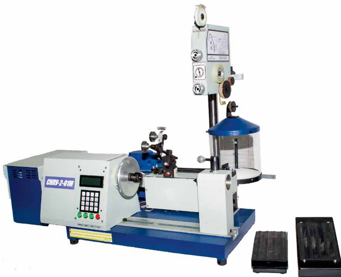
Рис. 4. Намоточный станок СНПУ-2-01МТ: внешний вид
