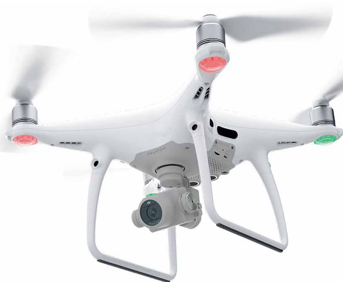
Рис. 4. Профессиональный квадрокоптер для аэровидеосъемки с кардановым подвесом
