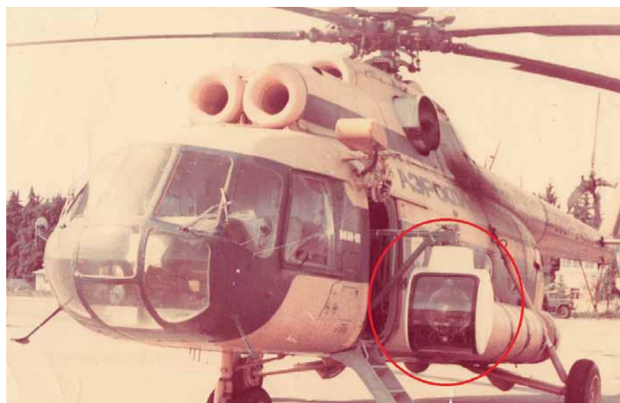
Рис. 5. Гиросtabilизатор 2ГСП, установленный на вертолете
