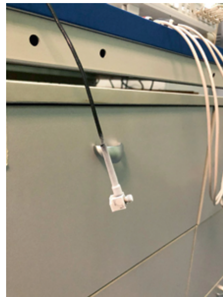
Рис. 5. Внешний вид установки для испытания датчика на предельную пониженную температуру
