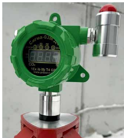
Рис. 2. Датчик Д4 в арктическом исполнении, установленный на объекте
