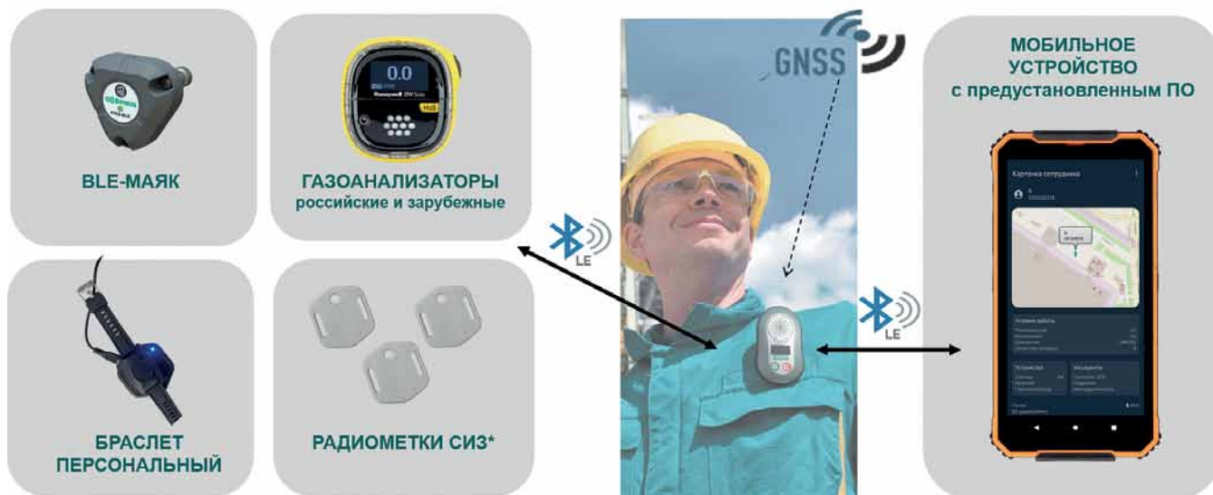
Рис. 4. Состав системы мониторинга персонала LoRaMesh
