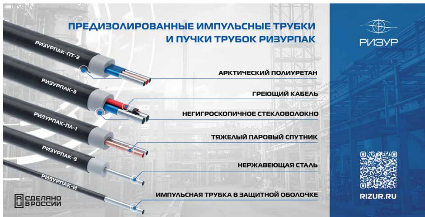
Рис. 4. Предизолированные импульсные трубки РИЗУРПАК: особенности разных серий
