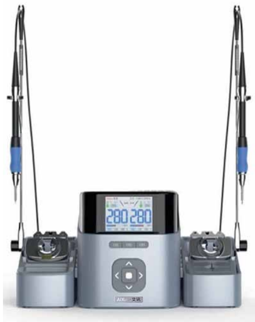
Рис. 1. Двухканальная паяльная станция AiXun T420D с двумя паяльниками
