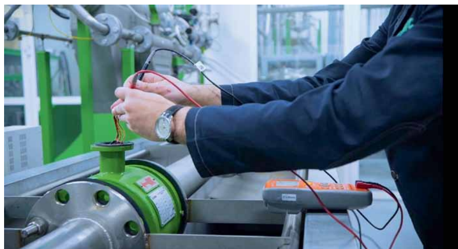
Рис. 4. Замер электрического сопротивления с помощью измерителя LCR
