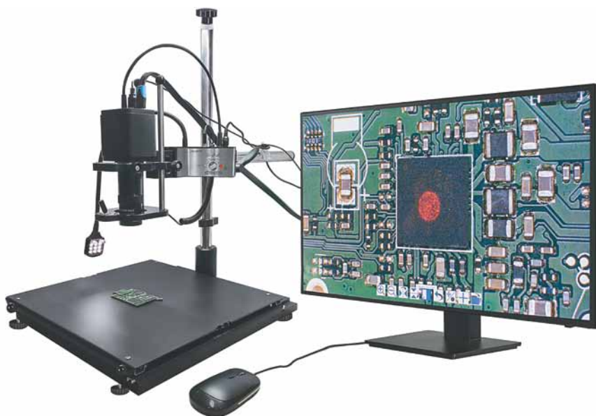
Рис. 9. Видеомикроскоп для контроля печатных плат
