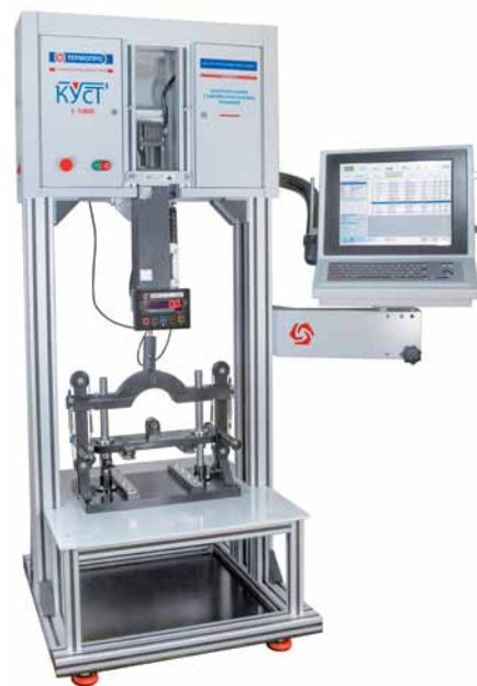
Рис. 7. Технологический стенд «Куст» для контроля усилия стыковки/расстыковки электрических разъемов
