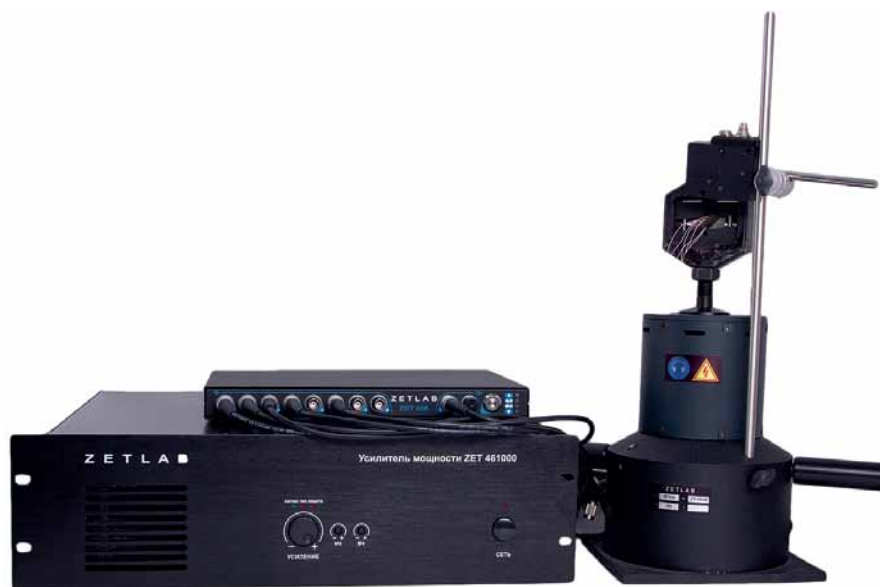
Рис. 1. Вибрационная установка для усталостных испытаний лопаток ГТД
