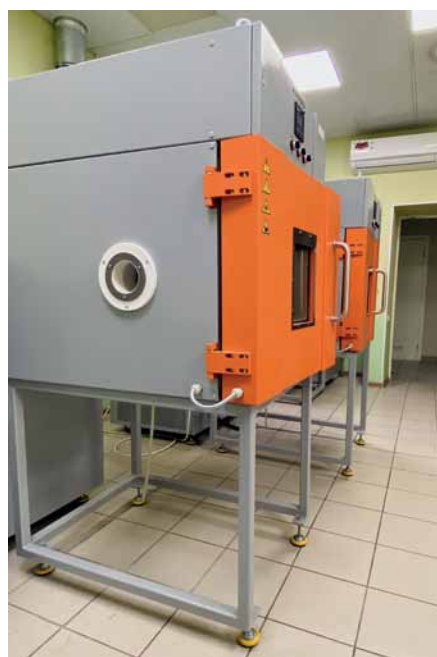
Рис. 1. Климатическая камера КТХ-150: а – общий вид; б – дополнительное окно; в – внутренний объем
