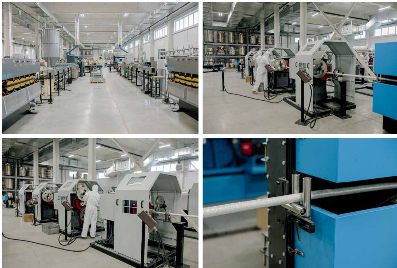
Рис. 2. Производство предизолированных импульсных трубок и пучков трубок РИЗУРПАК
