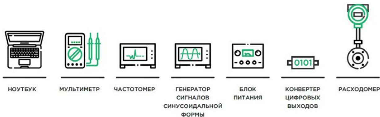
Рис. 2. Оборудование, с помощью которого можно выполнять поверку вихревого расходомера «ЭМИС-ВИХРЬ 200» имитационным методом
