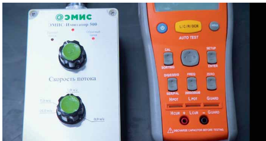
Рис. 3. Имитатор расхода «ЭМИС-Имитатор 500» и измеритель LCR
