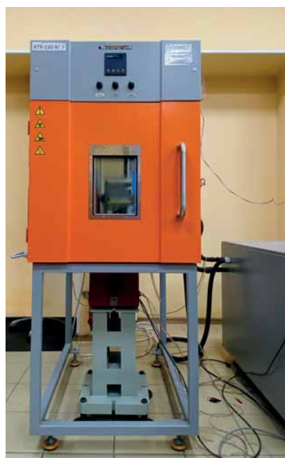
Рис. 1. Климатическая камера КТХ-150: а – общий вид; б – дополнительное окно; в – внутренний объем
