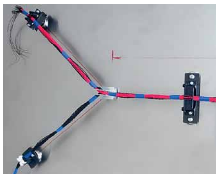
Рис. 2. Магнитные держатели «Термопро» на плазме с металлизированной поверхностью
