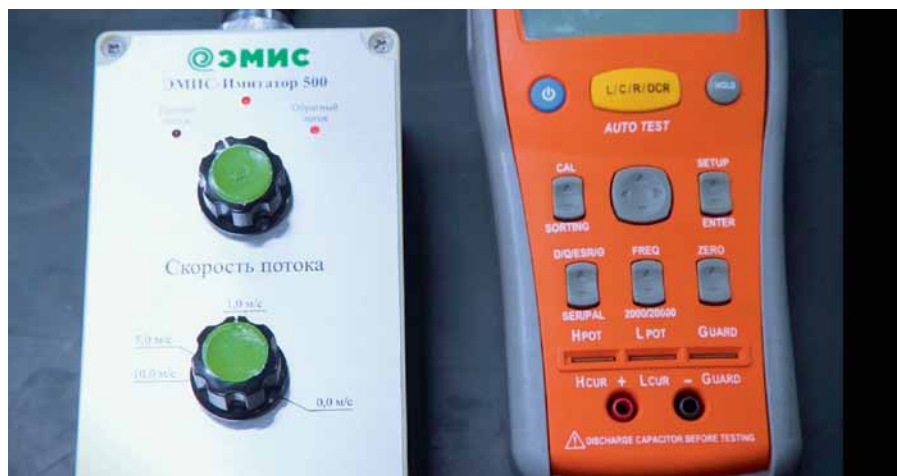
Рис. 3. Имитатор расхода «ЭМИС-Имитатор 500» и измеритель LCR
