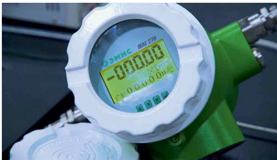
Рис. 5. Проверка установки нуля
