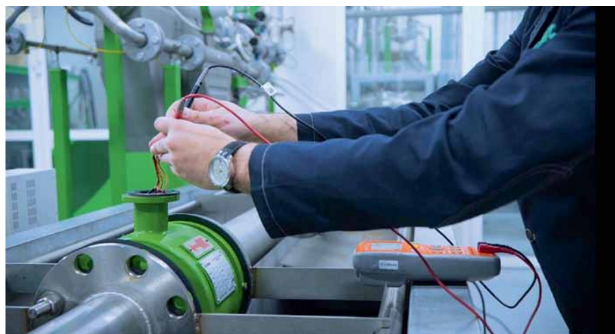
Рис. 4. Замер электрического сопротивления с помощью измерителя LCR
