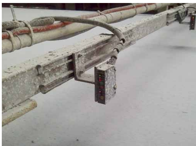
Рис. 1. Пример запыленности среды оптического датчика
