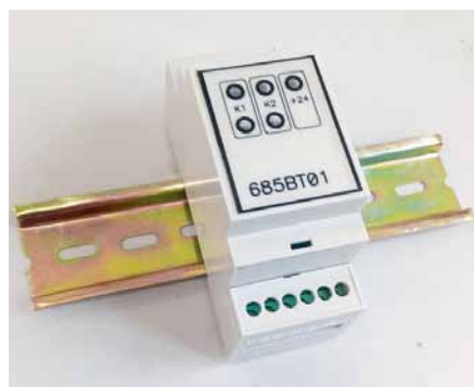
Рис. 2. Вибровыключатель модели 685BT01: установка на DIN-рейку и выполнение настроек
