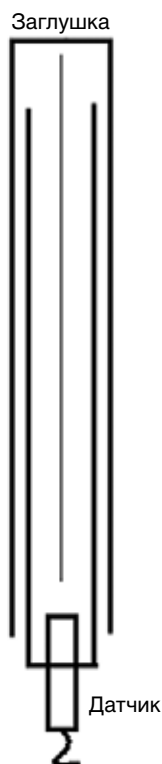
Рис. 4. Эскиз установки лазерного измерителя в телескопическую трубу
