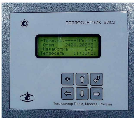
Рис. 3. Внешняя панель счетчика ВИСТ.Т с ЖК-дисплеем
