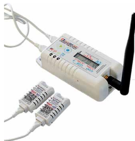
Рис. 3. Радиомодемный блок с усиленной антенной
