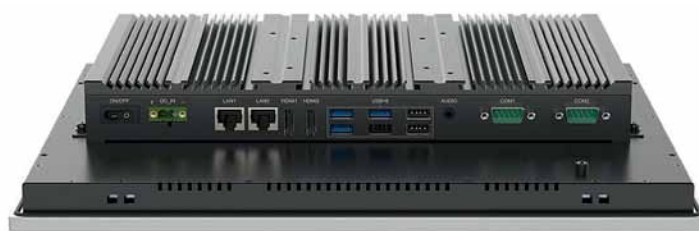
Рис. 2. Корпус системного блока компьютера TPC-DRS190W значительно меньше корпуса 19-дюймового сенсорного монитора
