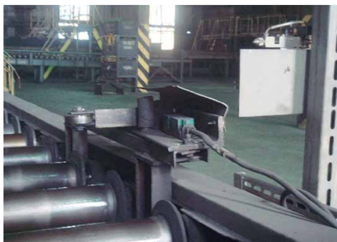
Рис. 2. Пример защиты индуктивного датчика от металлосодержащей пыли
