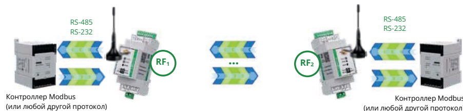
Рис. 2. Радиодлинитель RS-485 / RS-232 «точка – точка» на двух модемах PROMODEM RF
