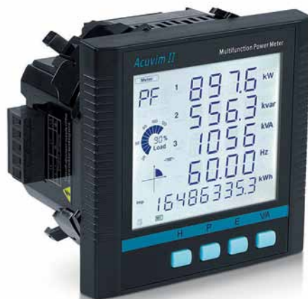
Рис. 1. Анализатор качества электроэнергии Acuvim II
