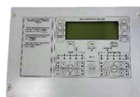
Панель контроля и индикации (ПКИ)
