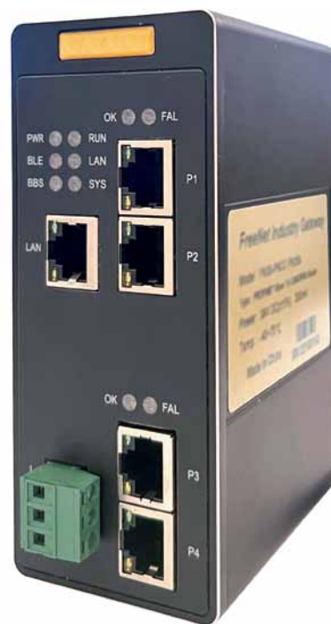
Рис. 5. Преобразователь цифровых сигналов из одних протоколов в другие
