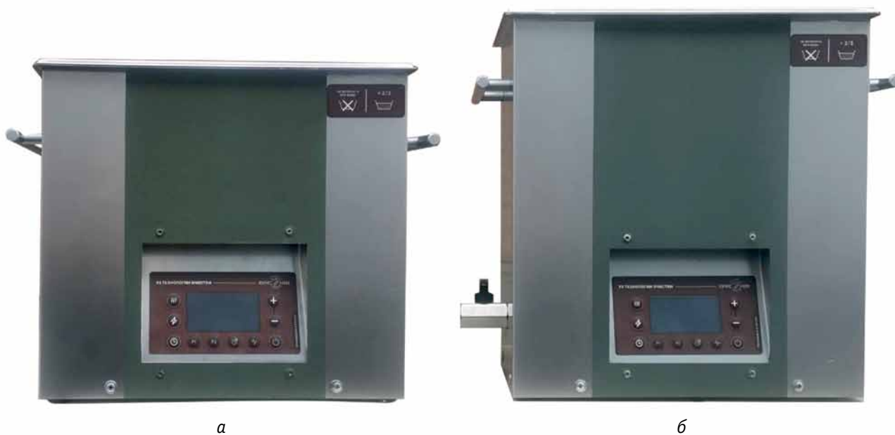
Рис. 2. Ванны «ХимСоник» СТАНДАРТ: а – без вентиля для слива жидкости (УЗВ до 5,7 л); б – с вентилем (от 5,7 л)
