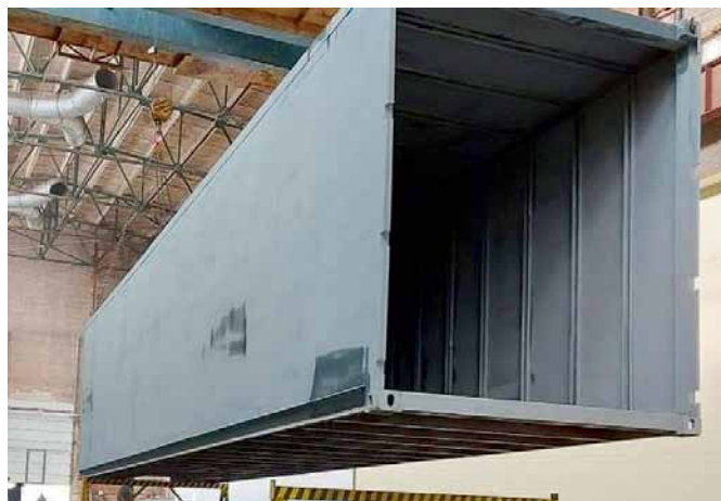
Рис. 8. Контейнер для перевозки грузов на морских судах, обработанный составом класса ZINKER
