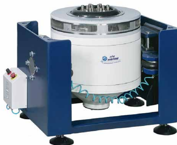
Рис. 6. Электродинамический вибростенд ETS Solutions серии LS
