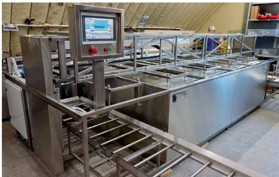
Рис. 2. Автоматизированная линия ультразвуковой очистки
