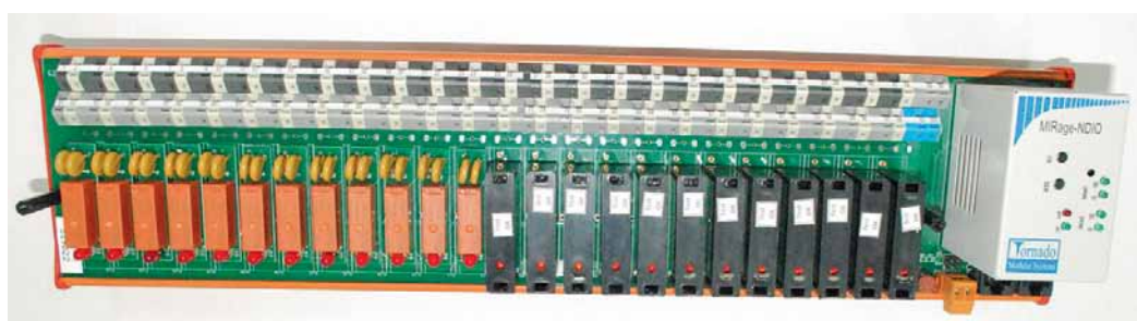
Рис. 2. Примеры модулей серии MIRage-N: а – MIRage-N485 для подключения устройств с интерфейсом RS-485 к сетям Ethernet; б – MIRage-NDI-C для ввода дискретных сигналов от датчиков типа «сухой контакт»; в – MIRage-NPT для преобразования сигналов термосопротивлений; г – MIRage-NTHERM для преобразования сигналов термопар; д – MIRage-NDIO для ввода/вывода дискретных сигналов
