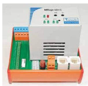
Рис. 2. Примеры модулей серии MIRage-N: а – MIRage-N485 для подключения устройств с интерфейсом RS-485 к сетям Ethernet; б – MIRage-NDI-C для ввода дискретных сигналов от датчиков типа «сухой контакт»; в – MIRage-NPT для преобразования сигналов термосопротивлений; г – MIRage-NTHERM для преобразования сигналов термопар; д – MIRage-NDIO для ввода/вывода дискретных сигналов
