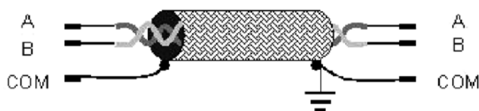
Рис. 1. Интерфейс RS-485: витая пара
