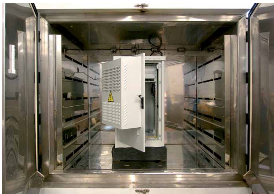
Рис. 7. Климатическая камера с установленным для испытаний шкафом ШТВ-1
