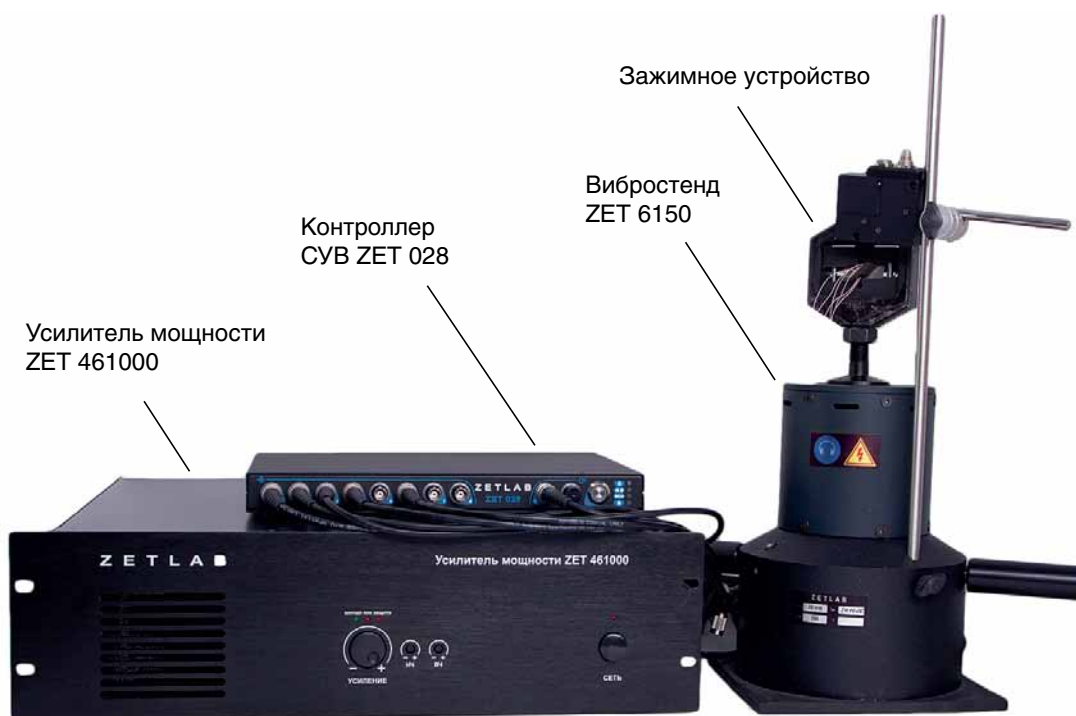
Рис. 1. Установка для усталостных испытаний лопаток ГТД на базе пьезокерамического вибростенда ZET 6150
