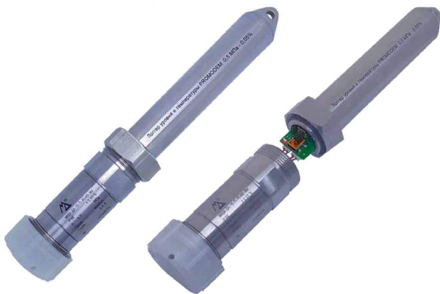
Рис. 1. Внешний вид логгера уровня и температуры PROMODEM
