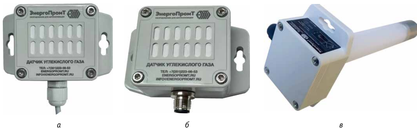
Рис. 2. Датчики CO 2 серии ДУГ 24 различных исполнений: а – настенный с кабелем; б – настенный с разъемом; в – канальный с кабелем
