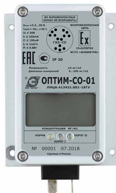
Рис. 3. Электрохимический датчик угарного газа «ОПТИМ-СО»
