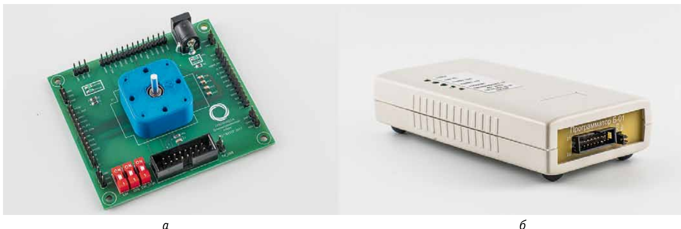
Рис. 3. Отладочный комплект микросхемы K1382NM025: а – демонстрационная плата 72 × 80 мм; б – программатор Б-01 (конвертер интерфейсов USB/SPI)
