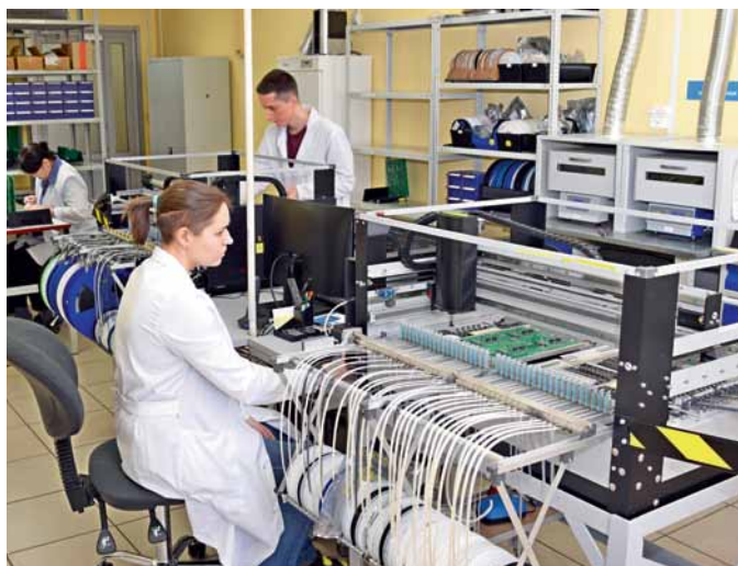
Рис. 4. Контроллеры «АБАК ПЛК» изготавливаются на высокотехнологичном производстве с применением линий автоматического монтажа электронных компонентов
