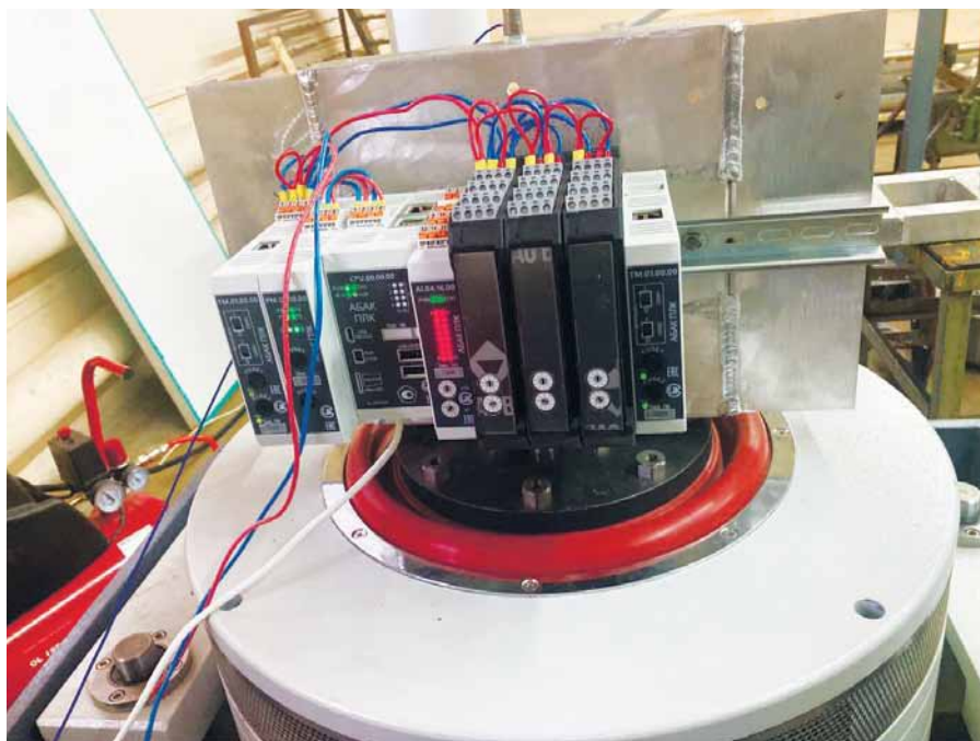
Рис. 1. Испытания «АБАК ПЛК» на электродинамическом вибростенде
