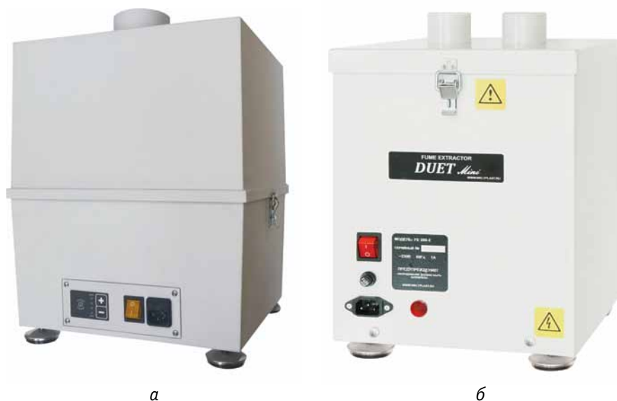
Рис. 1. Дымоуловители линейки DUET, примеры модификаций: а – DUET FE 300-2 i в пластиковом корпусе; б – DUET FE-250-2A для двух рабочих мест, с датчиком состояния фильтра
