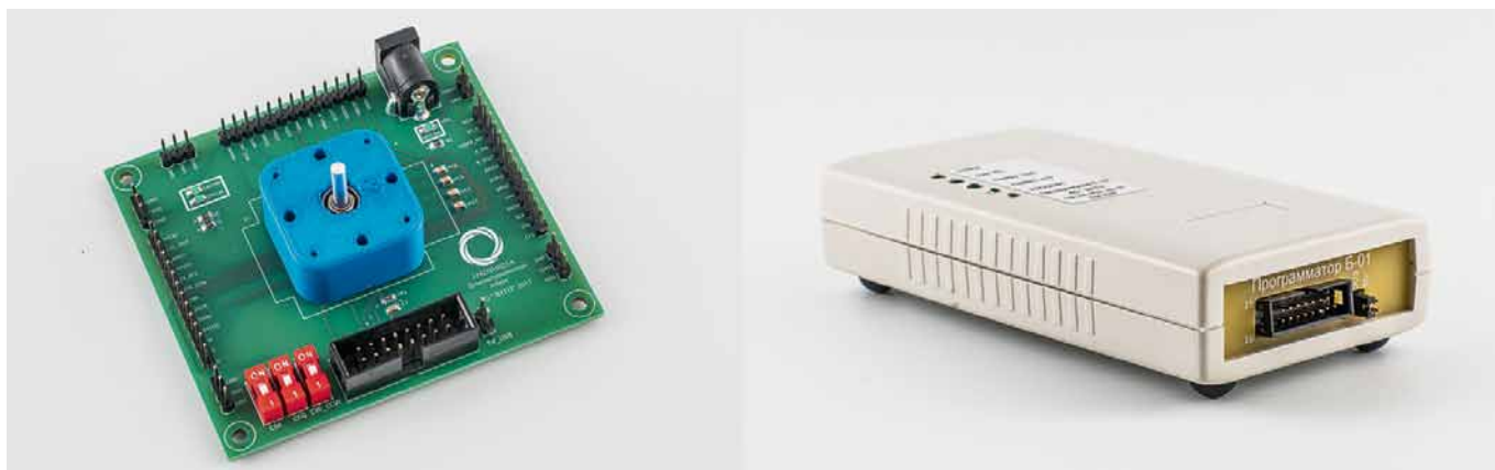
Рис. 3. Отладочный комплект микросхемы K1382HM025: а – демонстрационная плата 72 × 80 мм; б – программатор Б-01 (конвертер интерфейсов USB/SPI)
