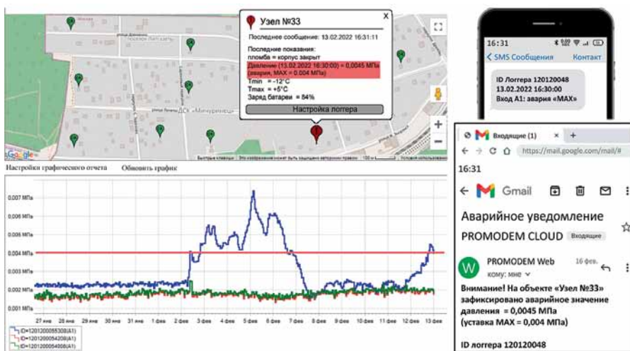
Рис. 3. Извещения об аварийных событиях: слева – индикация на веб-карте системы диспетчеризации PROMODEM CLOUD; справа – примеры аварийных e-mail- и СМС-сообщений на телефоны сотрудников
