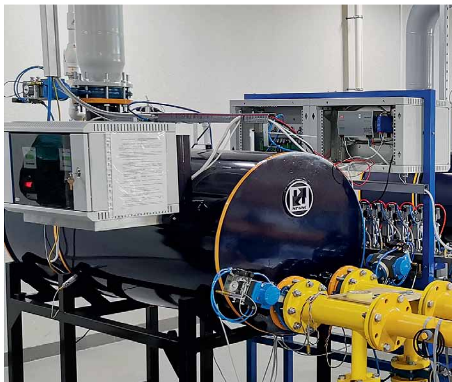
Рис. 2. Поверочная газодинамическая установка ИРВИС-УПГ-М
