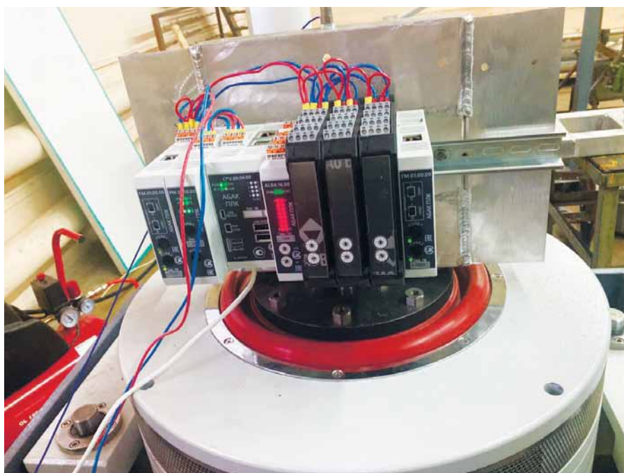
Рис. 1. Испытания «АБАК ПЛК» на электродинамическом вибростенде
