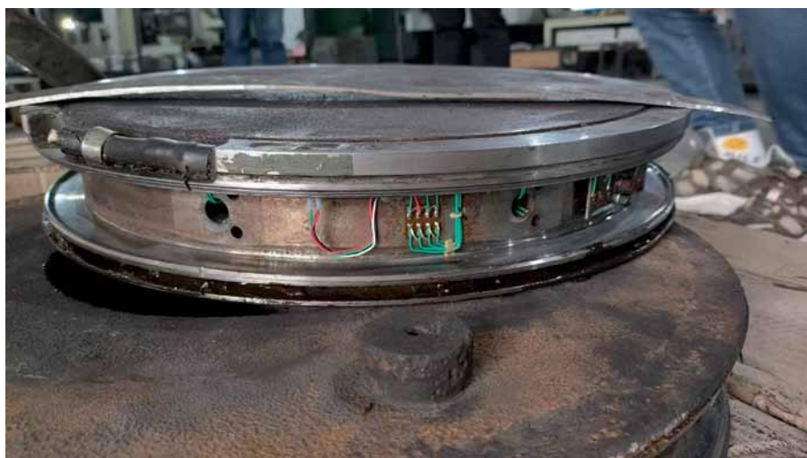
Рис. 2. Вышедшая из строя месдоза, отправленная для исследования на завод KELI
