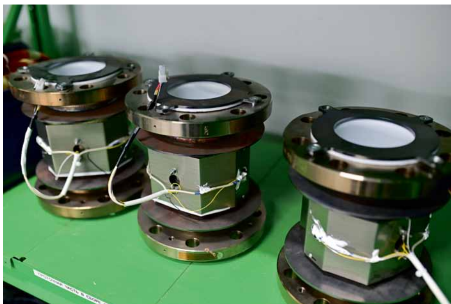
Рис. 2. Полуфабрикат электромагнитного расходомера «ЭМИС-МАГ 270» после процесса сварки
