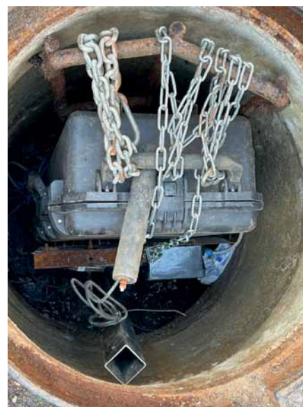
Рис. 4. Испытание системы анализа газовой среды в канализационных колодцах «АСАКС-ГАЗ»
