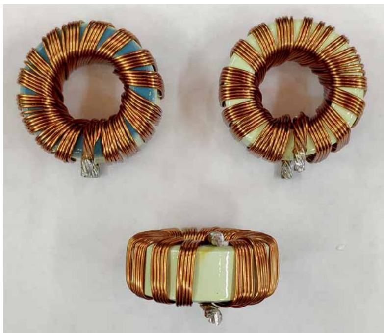
Рис. 13. Дроссель на распыленном железе
