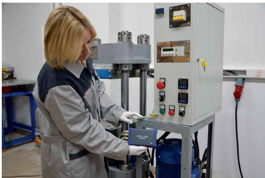
Рис. 4. Портативный анализатор спектра ZET 030 – удобный инструмент для мобильного вибромониторинга
