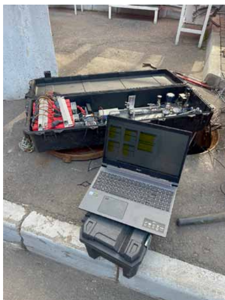
Рис. 4. Испытание системы анализа газовой среды в канализационных колодцах «АСАКС-ГАЗ»
