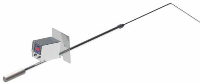
Рис. 2. Термозонды для кратковременных измерений температуры расплавов металлов и солей
