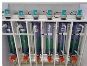
Рис. 4. Датчики для агрессивных сред: кислот и щелочей
