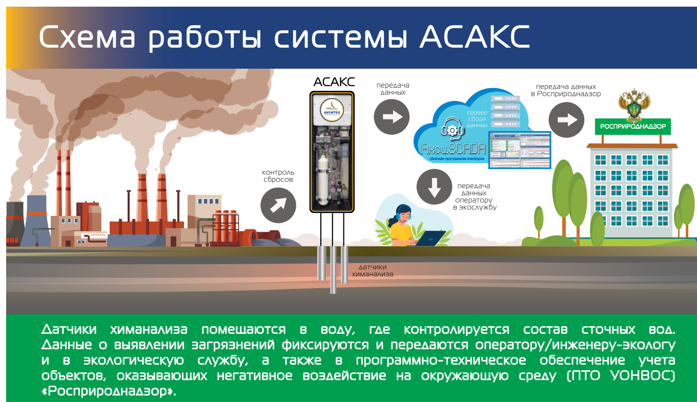
Рис. 3. Схема работы системы «АСАКС» в водной среде
