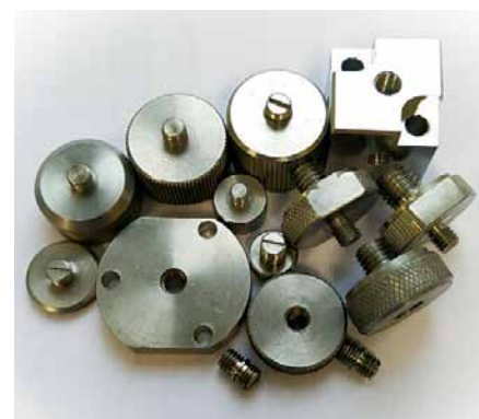
Рис. 4. Адаптеры для установки акселерометров «ВиброТест»
