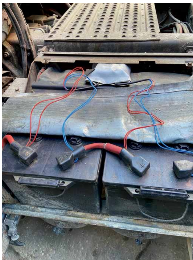
Рис. 4. Система балансировки «СВ3-2 2К-12В», установленная на аккумуляторах большегруза
