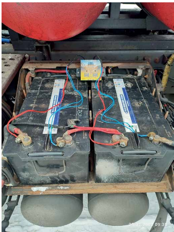
Рис. 4. Система балансировки «СВ3-2 2К-12В», установленная на аккумуляторах большегруза
