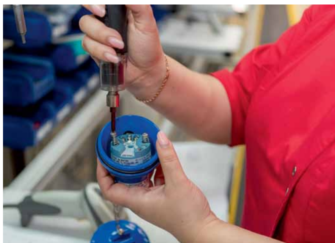
Рис. 4. «Метран-2700» можно использовать в контурах противоаварийной защиты благодаря сертификации с уровнем полноты безопасности SIL2/SIL3
