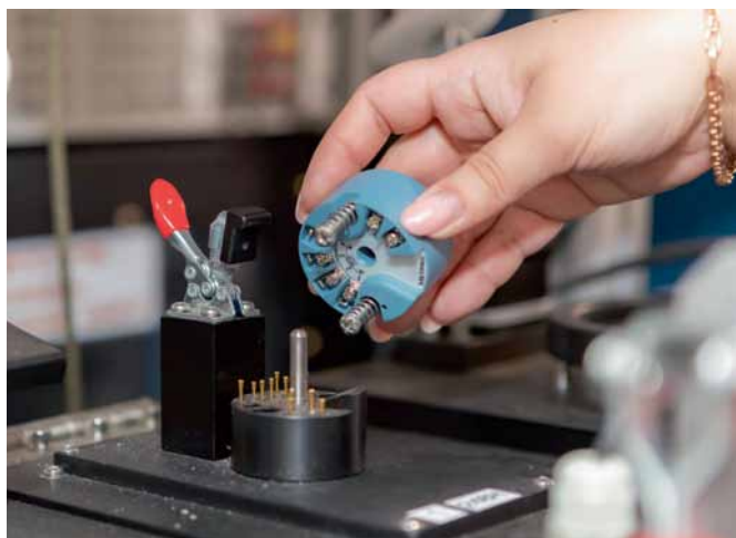
Рис. 3. Основная погрешность измерения первичного преобразователя Pt100, применяемого в ИП «Метран-2700», составляет \pm 0,1\text{ }^{\circ}\text{C}
