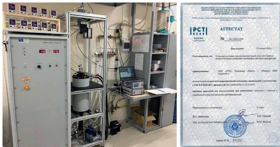
Рис. 5. Установка для калибровки высокотемпературных термопар (УКТ-2200)
