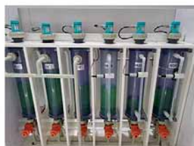
Рис. 4. Датчики для агрессивных сред: кислот и щелочей
