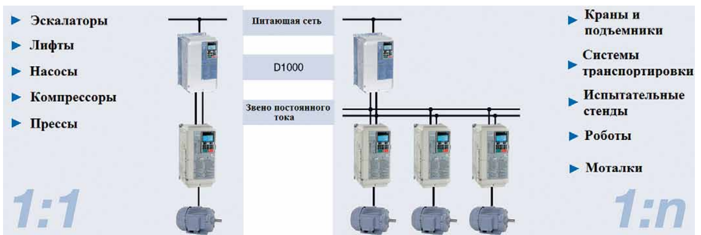
Рис. 1. Схема подключения рекуператора D1000
