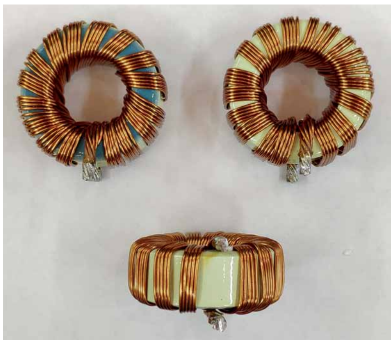
Рис. 13. Дроссель на распыленном железе
