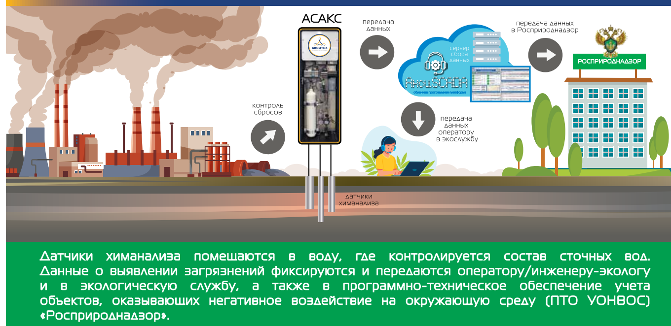
Рис. 3. Схема работы системы «АСАКС» в водной среде
