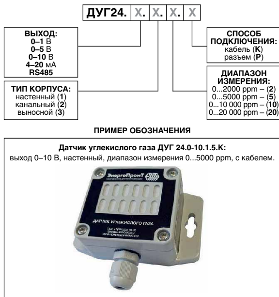
Рис. 2. Датчик углекислого газа ДУГ 24: формирование индекса модели, пример обозначения
