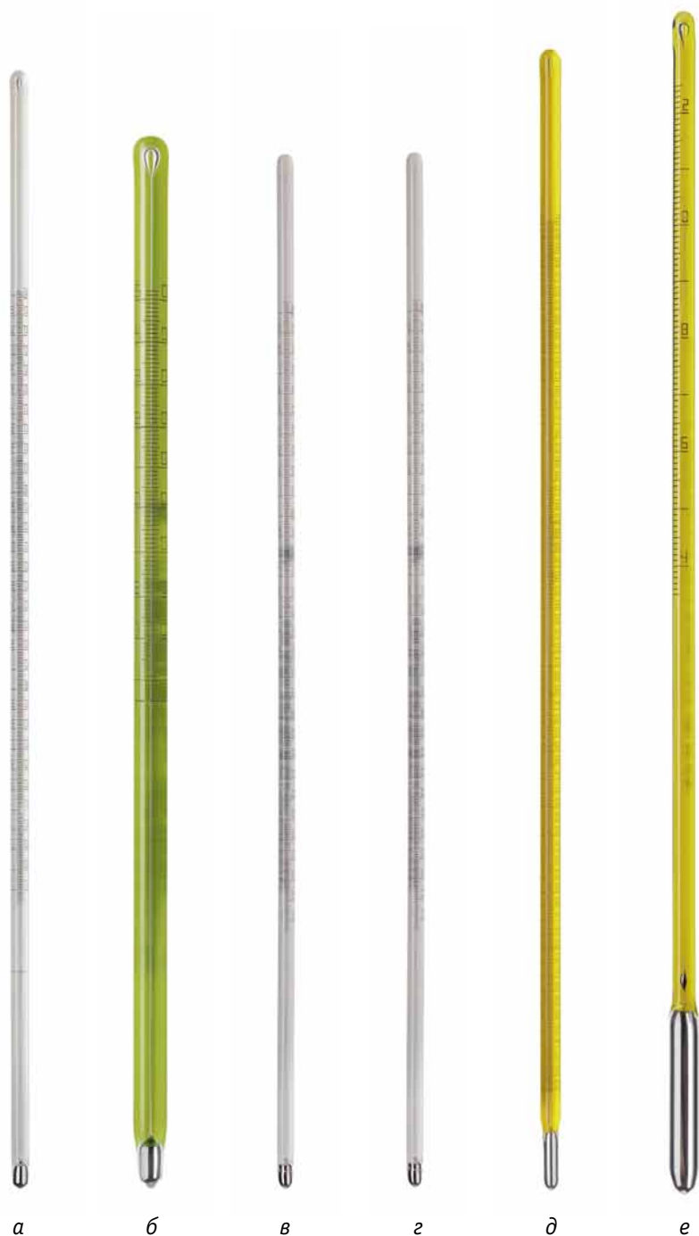
Рис. 1. Внешний вид стеклянных жидкостных термометров ASTM разных исполнений: а – 2С (диапазон -5...+300\text{ }^{\circ}\text{C} ); б – 5С ( -38...+50\text{ }^{\circ}\text{C} ); в – 7С ( -2...+300\text{ }^{\circ}\text{C} ); г – 8С ( -2...+400\text{ }^{\circ}\text{C} ); д – 12С ( -20...+102\text{ }^{\circ}\text{C} ); е – 18С ( +34...+42\text{ }^{\circ}\text{C} )
