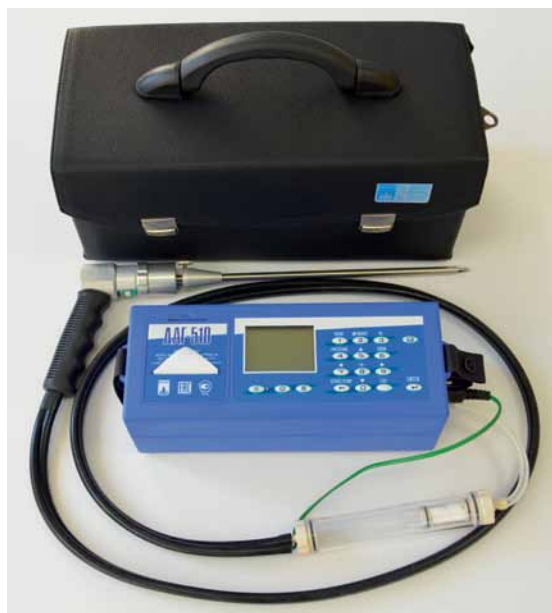
Рис. 2. Переносной газоанализатор ДАГ-510
