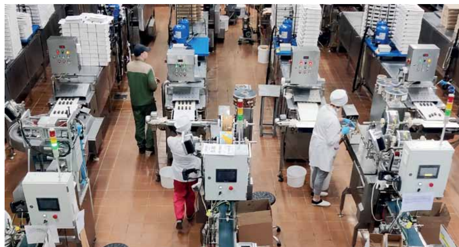
Рис. 3. Применение светосигнальных колонн на предприятии «РостАгроКомплекс»
