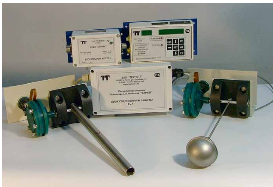
Рис. 1. Составные части расходомера-счетчика безнапорных потоков «СТРИМ»
