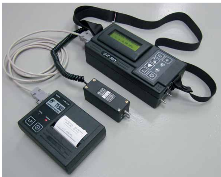
Рис. 1. Переносной газоанализатор ДАГ-500 с термопринтером ТП-500 и датчиком давления ДАГ-530
