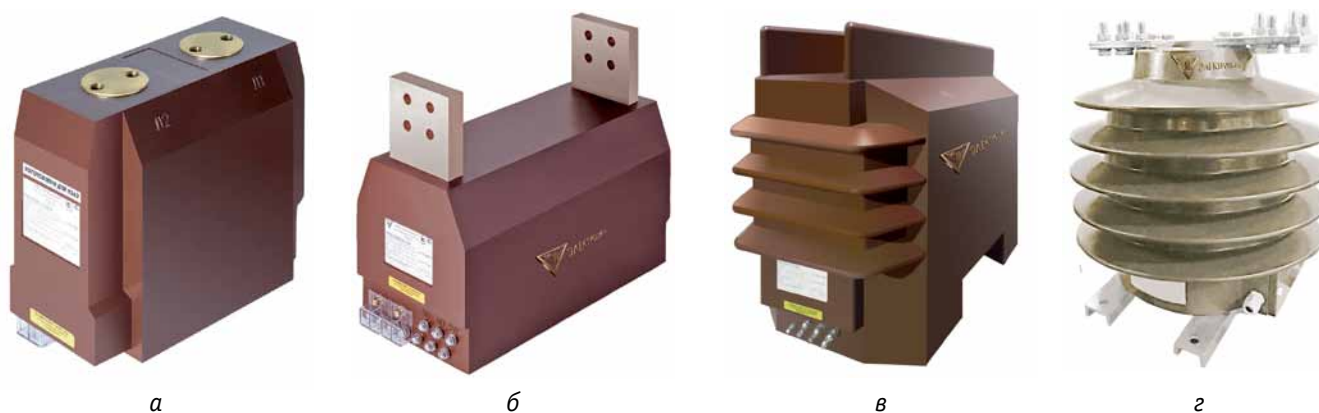
Рис. 1. Трансформаторы тока серии ТЛО-10 в различных исполнениях: а – ТЛО-10 М01 (от 5 до 2000 А; до 4 обмоток; с крышкой для пломбирования; вес до 21 кг, габариты 280 × 148 × 224 мм); б – ТЛО-10 М17 (от 5 до 4000 А; до 5 обмоток; с шинными контактами первичной обмотки; с крышкой для пломбирования; вес до 60 кг, габариты 382 × 180 × 314 мм); в – ТЛО-10 М22 (от 5 до 3000 А; до 5 обмоток; с крышкой для пломбирования; с изолирующими перегородками); г – ТЛО-10 МН30 (наружного исполнения; до 1500 А; до 3 обмоток; с переключением по первичной обмотке; вес до 90 кг; габариты 423 × 400 × 426)
